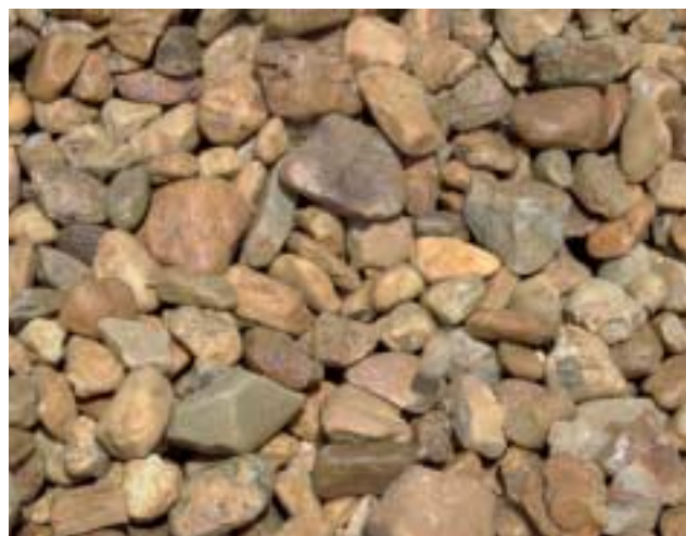
Bild 4: Durchgangsmaterial: Quarz mit hohem Eisengehalt
