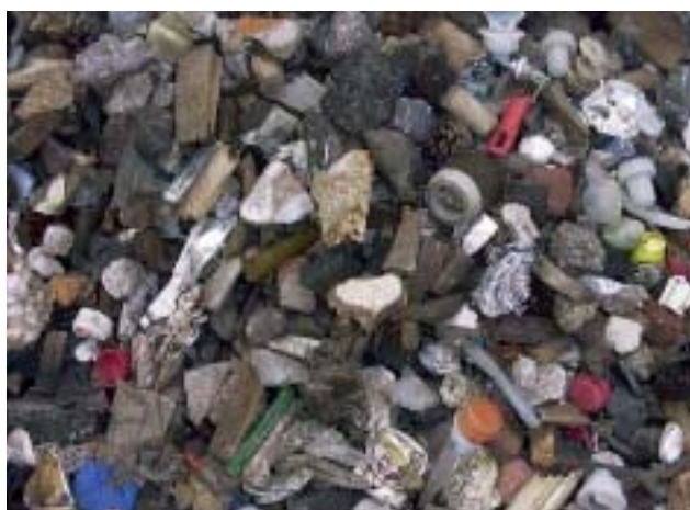
Bild 1: Probe einer gesichteten Schwerfraktion (30–60 mm) mit organischen und anorganischen Bestandteilen
