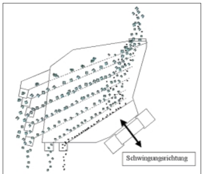
Bild 3: Prinzipskizze des SL Sizers Fig. 3: Schematic showing the principle of an SL Sizer
