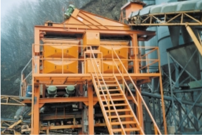
Bild 6: Betonwerk Lučka, 2. Siebstufe mit 2 Sizern SL 1566 (rückwärtige Ansicht) Fig. 6: Lučka Concrete, 2nd screening stage with two SL 1566 Sizers (rear view)
