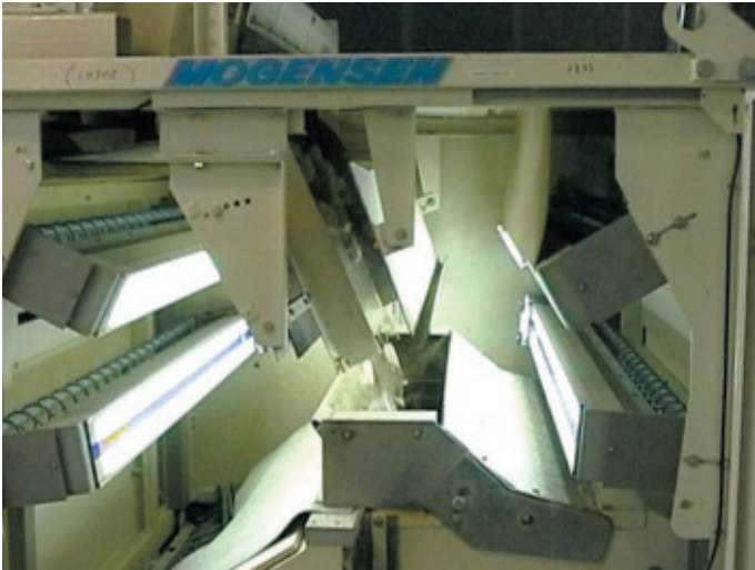
Bild 8: Abtast- und Trennbereich des MikroSort AH 1223 Fig. 8: Scanning and separation sections of the MikroSort AH 1223
