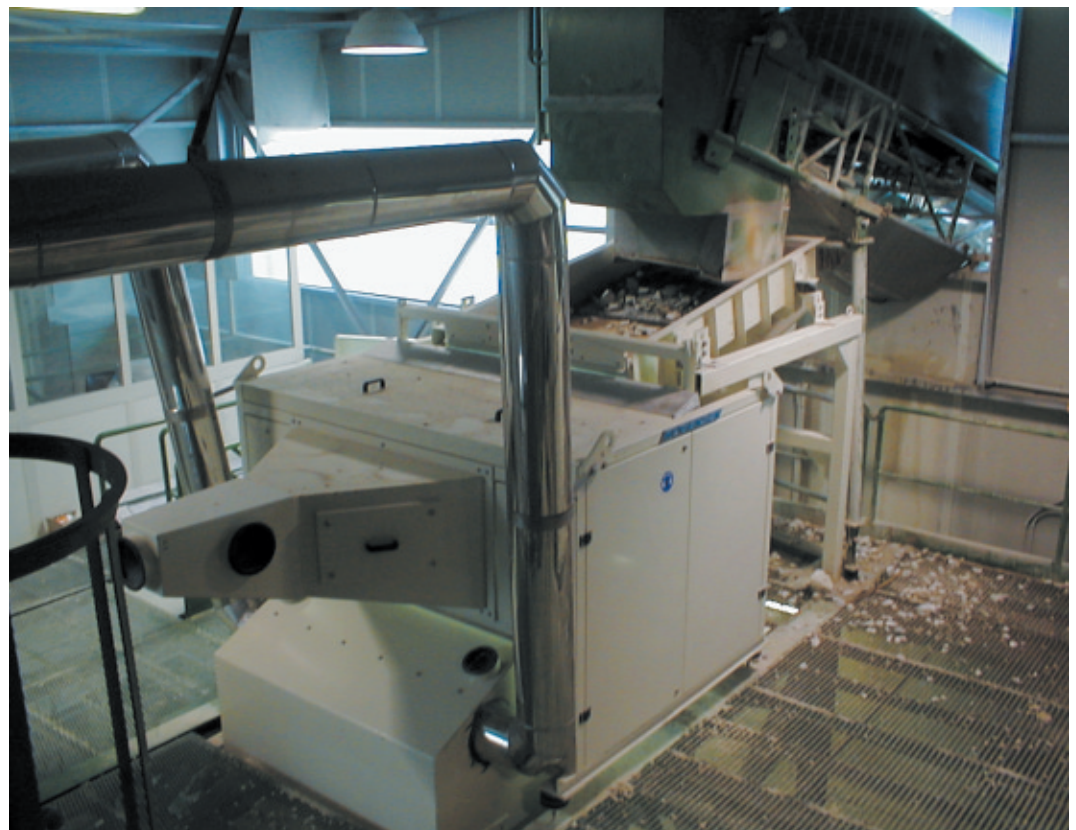
Bild 7: Sortiergerät MikroSort AH 1223 mit isoliertem Trennkasten. Die Absaugung des bei der Ausschleusung entstehenden Wassernebels erfolgt direkt an der Abweiskammer des Trennkastens
