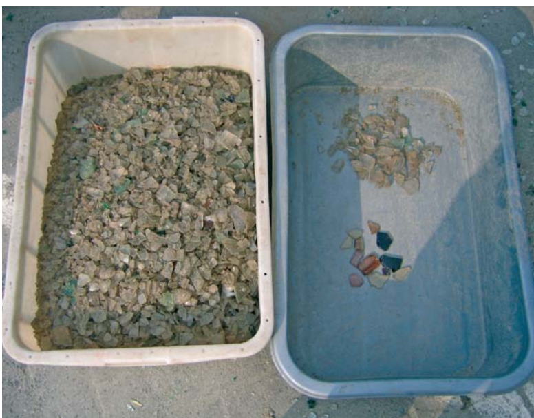
Figure 4 : MikroSort® AQ – Tri des vitrocéramiques - A droite la vitro rejetée et la perte en verre ; à gauche le verre trié
