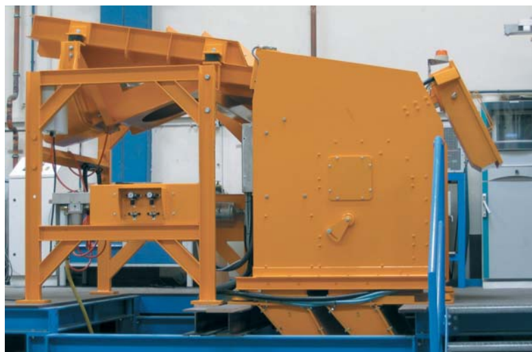
Figure 3 : MikroSort® AQ – Tri avec rayons X
