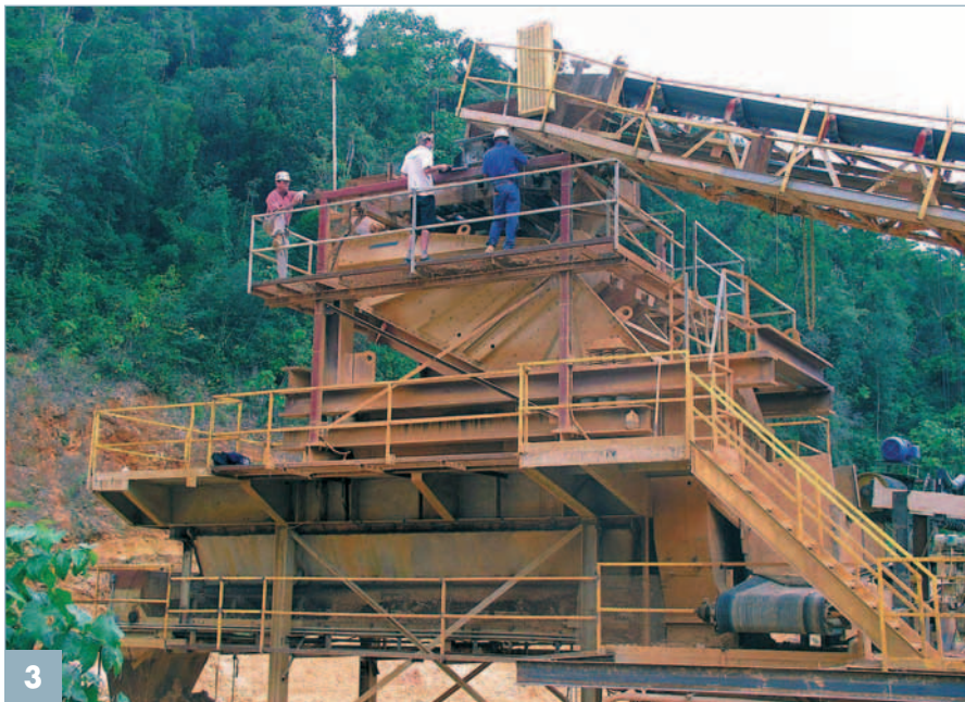
Installation de criblage avec Sizer vibrant à barres intégré au Porto Rico
