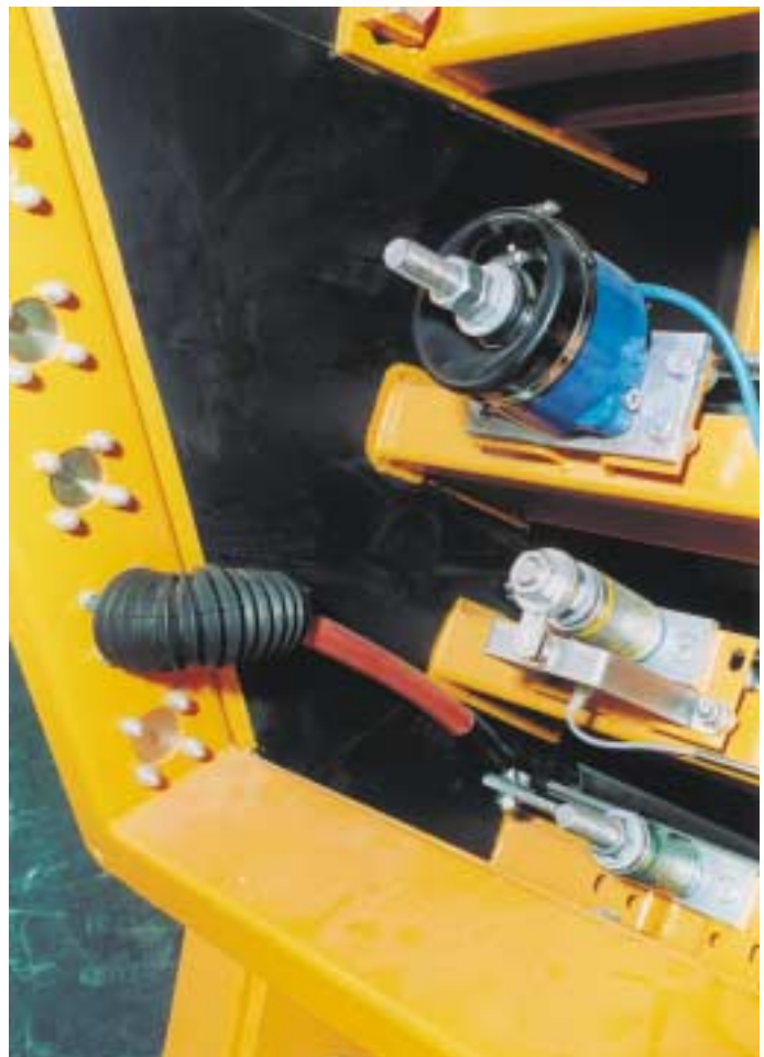
Bild 4: Rückseite eines Mogensen Sizers bei geöffneter Maschine mit pneumatischer Siebdeckreinigung, Siebüberwachung und Siebdeckheizung Fig. 4: Rear side of an opened Mogensen Sizer with pneumatic screen deck cleaning, screen monitoring and screen deck heating
