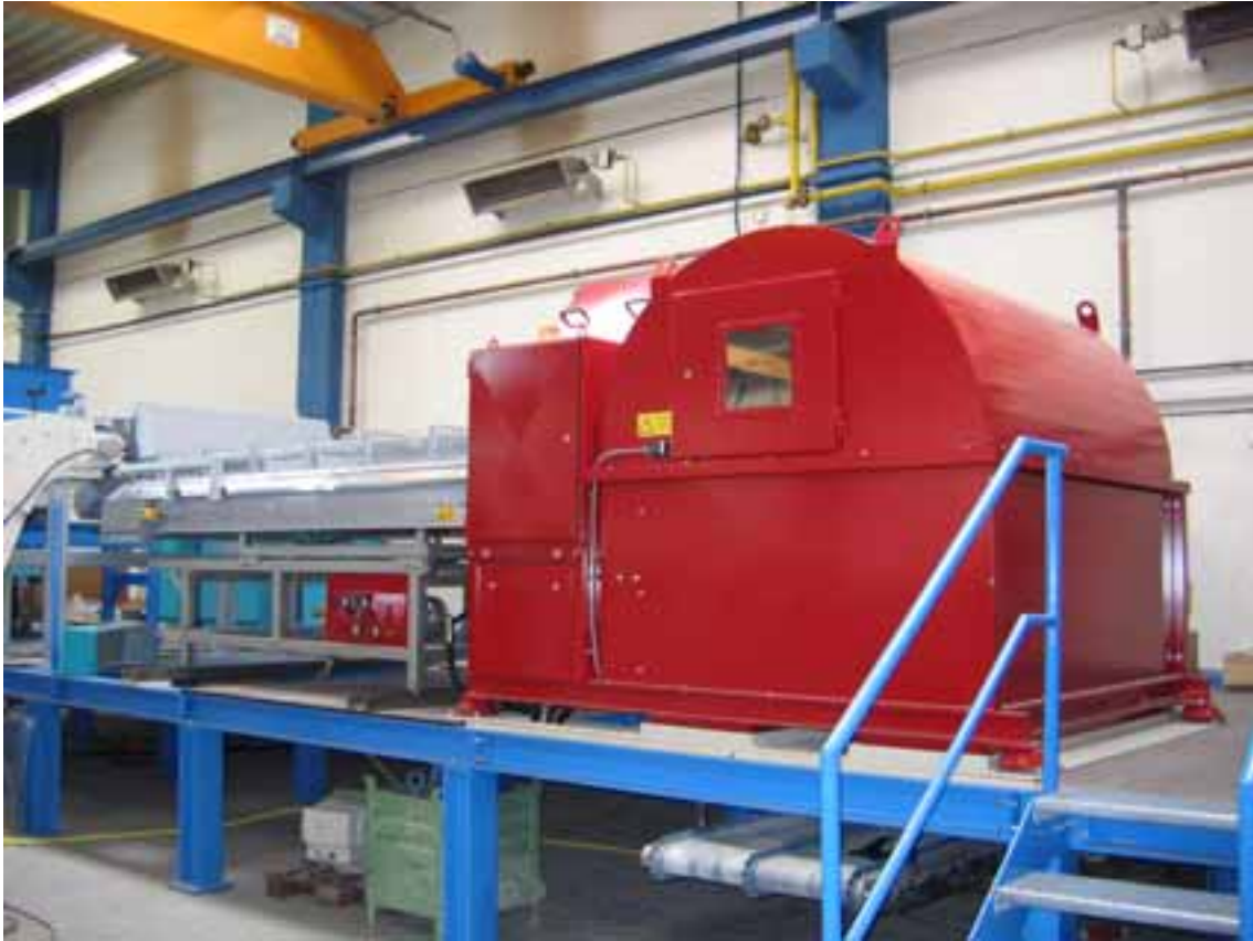
Bild 3: Mogensen MikroSort AR1200 mit vorgeschalteter Siebtechnik für großflächiges und bizarr geformtes Material
